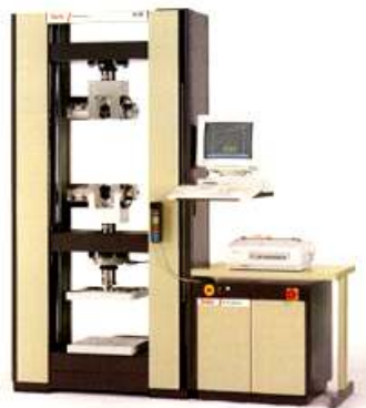
Figura 1. Dinamómetro universal Statimat M Textechno.
