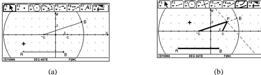
**Fig. 1.** Construcción de la elipse a partir de su definición.
