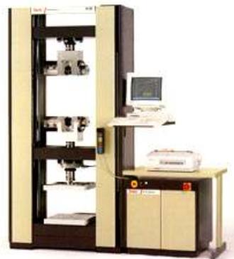
Figura 1. Dinamómetro universal Statimat M Textechno.
