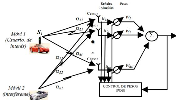
Figura 9: Modelo de señal para un arreglo lineal uniforme.
