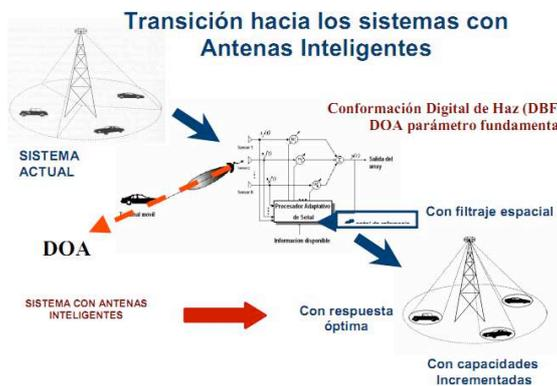
Figura 8: Transición hacia los sistemas con antenas inteligentes con direccionamiento de haz hacia la dirección angular DOA.
